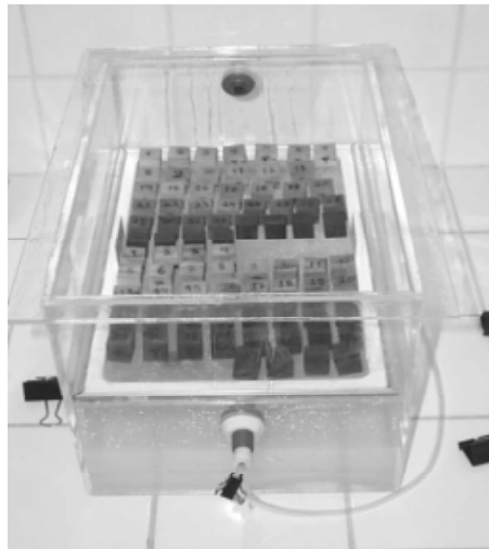
Figura 3 - Cuba de acrílico, com umidade relativa de 90 %, contendo os corpos-de-prova acima de uma solução saturada de sulfato de zinco ao fundo.
