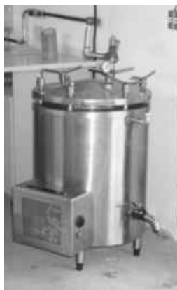
Figura 1 – Autoclave do LPF/IBAMA utilizada nos experimentos de tratamento térmico.
